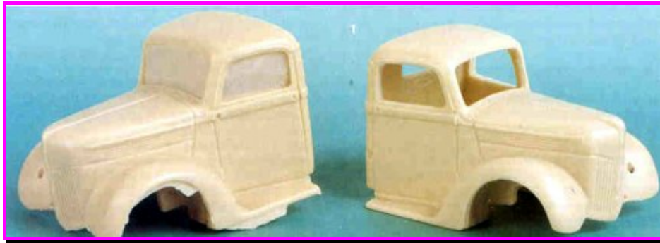
La cabine en résine polyuréthane du Ford V8 "Poissy", brute de démoulage à gauche, et ébarbée, poncée et prête au montage à droite.
